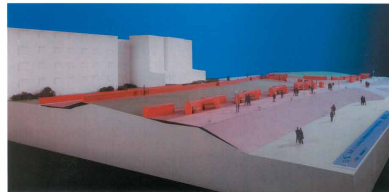
Abb. 8: Modell des zukünftigen Deckwerkes an der Georgshöhe mit oberhalb der oberen Wandelbahn angeordneten Schwallwänden sowie einer Kronenmauer als wellenlaufdämpfende Elemente
