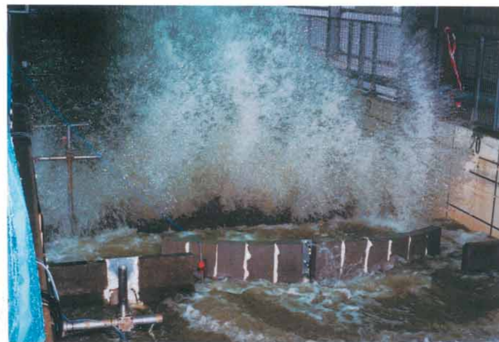
Abb. 5: Untersuchung der Wirkung von oberhalb der oberen Wandelbahn angeordneten Schallwänden auf den Wellenauflauf 1 Ausführung Forschungsstelle Küste 2 Ausführung Leichtweiß Institut der TU Braunschweig
