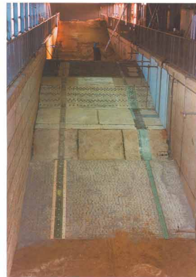
Abb. 4: Aufbau des Norderneyer Deckwerkes als maßstäbliches Modell im großen Wellenkanal des Forschungszentrums Küste in Hannover
